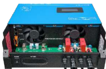
Interior del MPPT RS SmartSolar 450|100
